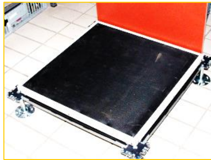
Fig. 2 Piezoelectric foot board shown at the "Festival della Scienza", Genova 2009
